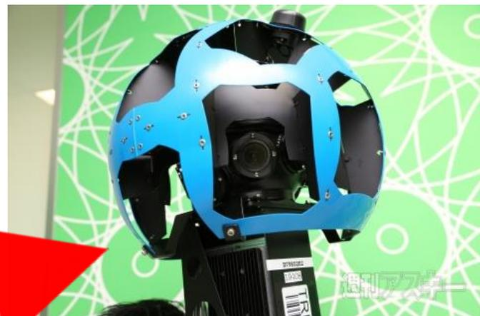
屋外のストリートビュー撮影ではこのような丸い形をした、360度カメラを車の上に固定して撮影をしています。
